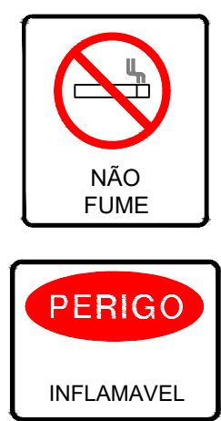
DETALHE PLACAS PLACA NA CENTRAL DE GLP SEM ESCALA
